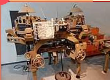
1985年頃まで空中写真から地図を作成する時に使っていた機械です。両手両足を使って機械を操作していました。隣にはドイツ製の貴重な立体図化機(青色の機械)も展示しています。
